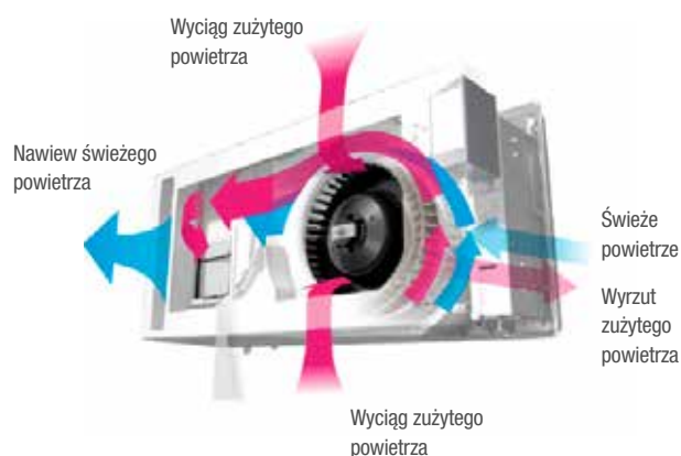
Przepływ powietrza na przykładzie decentralnego rekuperatora VL-50
