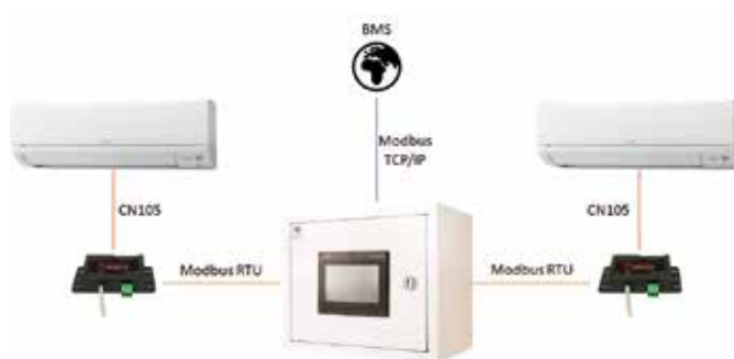
Schemat podłączenia panelu PAC-GT2104IF-E*
