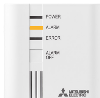
Błąd (czujnika, połączenia)
