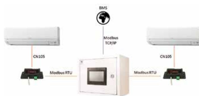
Schemat podłączenia panelu PAC-GT2104IF-E*
